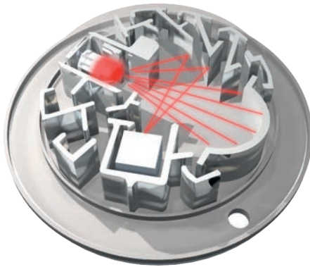
Normalläge: En lysdiod sänder ljus i en mörk labyrint i detektorhuset.
